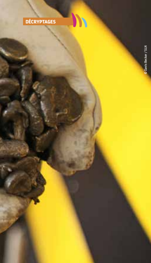
Le ferronickel (mélange de nickel et de fer) obtenu est ensuite transformé en grenaille, sorte de "chips" faciles à transporter et à manipuler.
